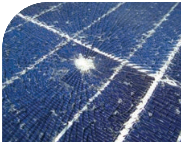
Slika 11: Oštećen fotonaponski panel
