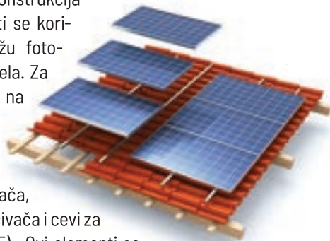
Slika 15: Elementi noseće konstrukcije
