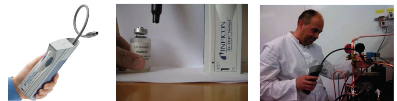
Slika 115: Izgled instrumenta infracrveni elektronski detektor curenja, njegova kalibracija i detekcija na rashladnom sistemu
