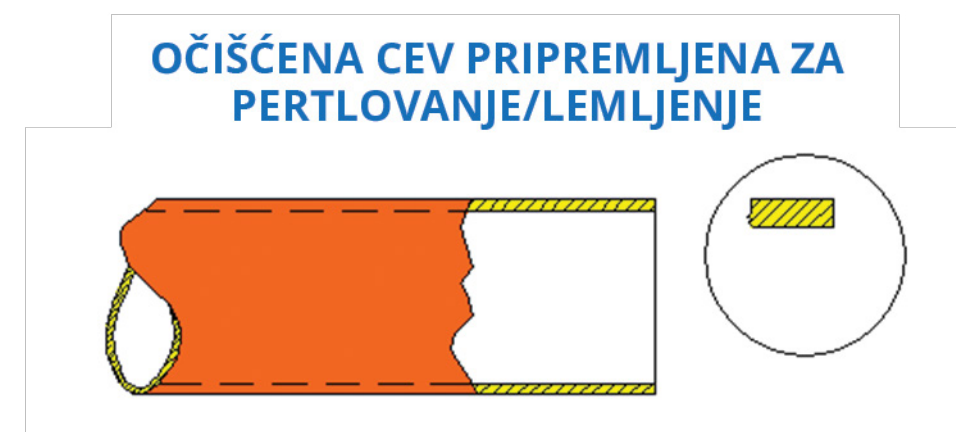
Slika 41: Pogled na cev nakon uklanjanja krajeva
