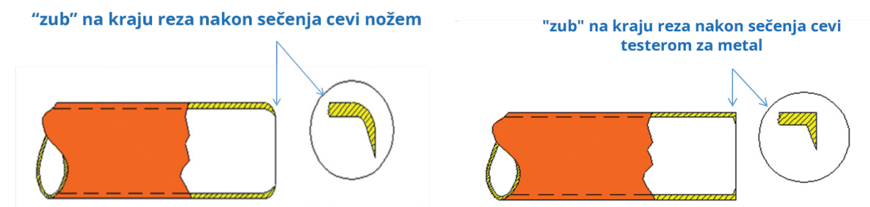
Slika 39: Izgled presečenog kraja pri sečenju rezačem za bakar i pri sečenju testerom (desno)
