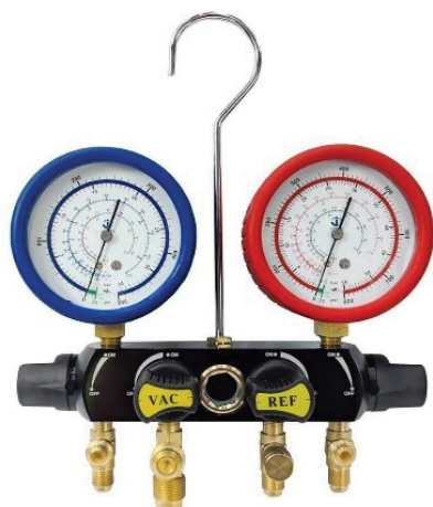
Slika 122: Set sa mehaničkim manometrima
