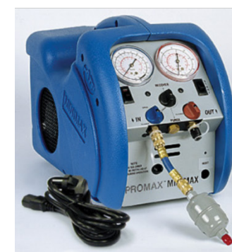
Slika 120: Uređaj za sakupljanje CFC, HCFC i HFC rashladnih fluida
