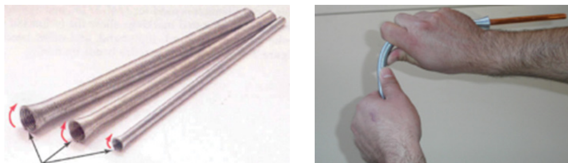
Slika 46: Opruge za ručno savijanje cevi
