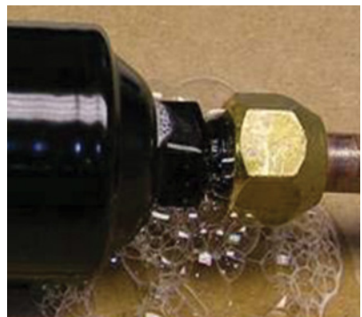
Slika 103: Curenje na holenderskom spoju
