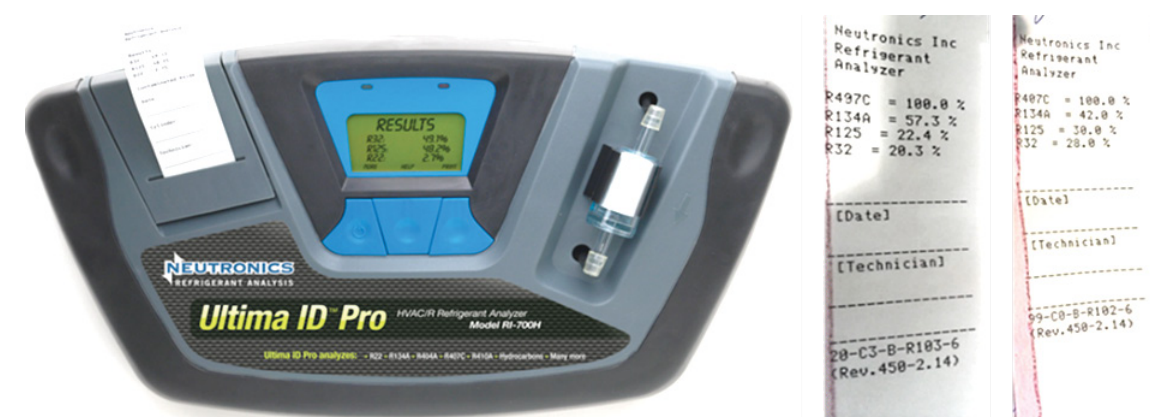
Slika 100: Analizator sastava freona i primer dva štampana izveštaja
