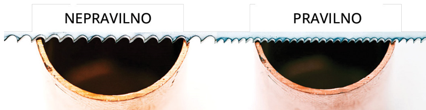
Slika 37: Poprečni presek bakarne cevi pri sečenju testerom sa ramom sa različitim brojem zuba
