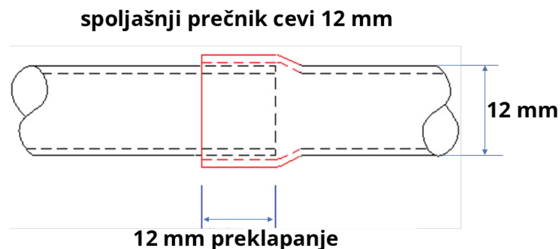
Slika 47: Proširivanje bakarnih cevi
