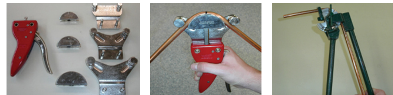
Slika 45: Alati za ručno savijanje cevi
