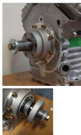
Slika 106: Curenje na zaptivci na vratilu otvorenih kompresora
