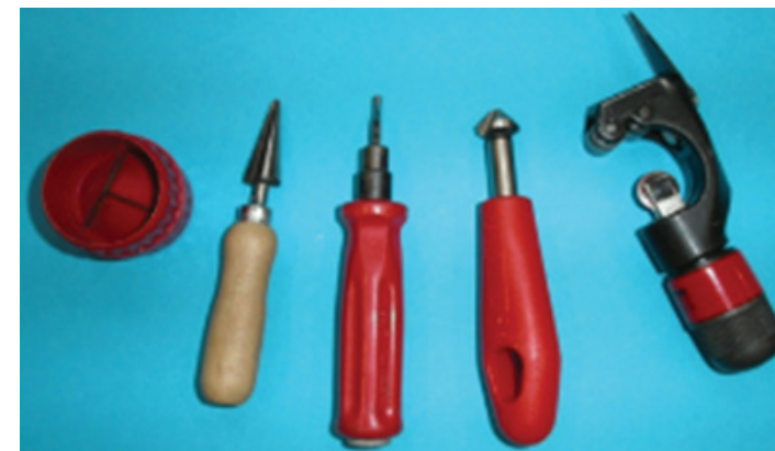
Slika 40: Različite vrste alata za čišćenje
