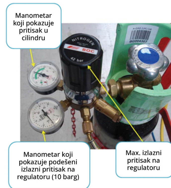
Slika 81: Boca sa azotom za ispitivanje pod pritiskom
