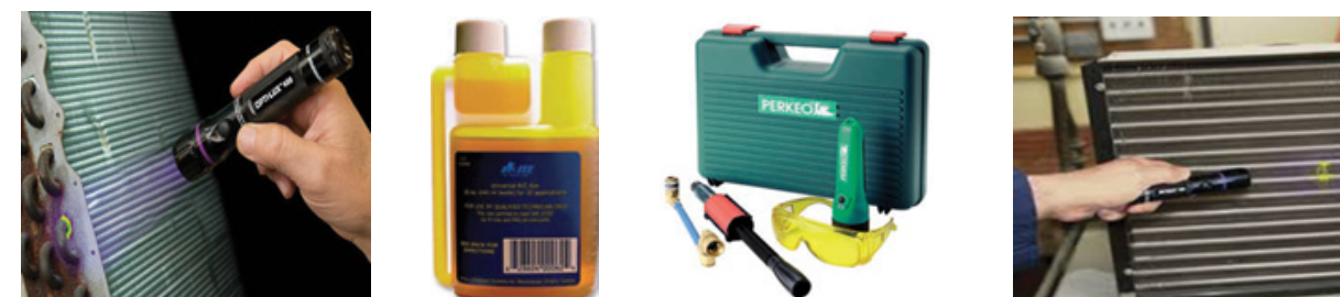
Slika 113: Test curenja ultravioletnom bojom i lampom
