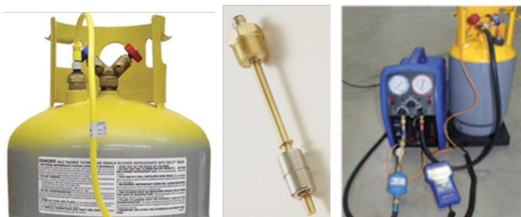
Slika 118: Cilindar za sakupljanje sa zaštitom od prepunjavanja i njegovo povezivanje
